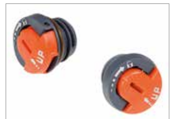
As tampas de óleo e mistura “EasyLift” são a solução mais prática para um acesso sempre pronto às zonas de reabastecimento. A pega superior, ergonómica e facilmente dobrável, garante a sua utilização sem recorrer a ferramentas.
