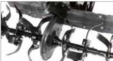
O cárter que cobre a transmissão é reforçado para resistir a pedras e choques acidentais.
