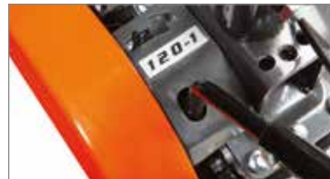
Selector de mudanças externo, ergonómico e de fácil acesso.
