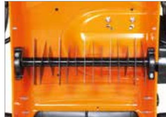
Rotor composto por 15 lâminas fixas.
