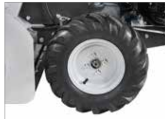
Jelentős méretű gumis kerekek (4,00-8") garantálják a kiváló tapadást a talajhoz.
