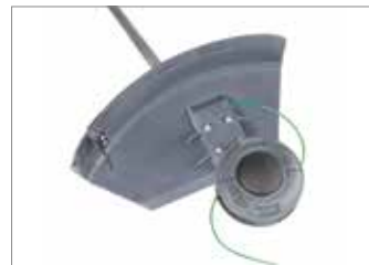
Tap&Go EVO Ø 130 mm fej, Ø 2,4 mm szál, Tap&Go működés.
