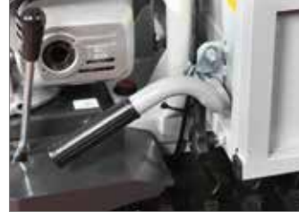
Ручное опрокидывание с автоматической системой блокировки.
